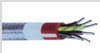
**CAVI TIPO FG4OG4/A/T2:** Conduttori in fili di rame rosso o rame stagnato, isolamento in gomma siliconica, guaina di gomma silicone, armatura, temperatura di esercizio - 60° + 180° C.
