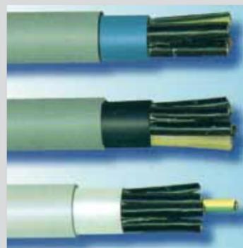
**CAVI DI ENERGIA, SEGNALAZIONE E COMANDO ARMATI:** A questa tipologia appartengono tutti o cavi a cui necessiti una protezione meccanica dovuta al particolare tipo di posa o di impiego. La suddetta armatura è costituita da una treccia di fili di acciaio ricotto con protezione anticorrosiva. Gli angoli di incidenza della treccia sul cavo sono calcolati per garantire la massima flessibilità del medesimo senza penalizzare la protezione.
