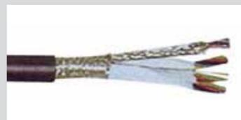
**CAVI A COPPIE SINGOLARMENTE SCHERMATE:** a treccia di rame rosso o stagnato, con copertura all'85%. Riunitura a contatto. Utilizzati per collegamenti a lunga distanza tra unità centrale e stazioni periferiche, adatti per posa con cavi di alimentazione.
