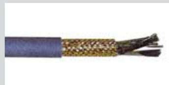
**CAVI SCHERMATI:** a treccia di rame rosso o stagnato per impianti di segnalazione, misura, comando e regolazione. Versioni con anime colorate o numerate e guaine a richiesta: antifiamma, antiolio, ridotta emissione di fumi e gas tossici, HT 105°, resistenti agli idrocarburi, per basse temperature ecc.
