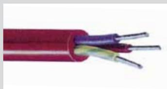
**CAVI TIPO FG4OG4:** conduttori in fili di rame rosso o rame stagnato, isolamento in gomma siliconica, guaina di gomma silicone, temperatura di esercizio - 60° + 180° C.
