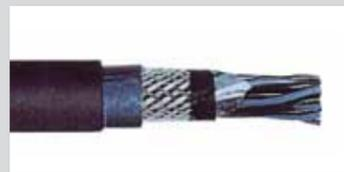
**CAVI CON RIUNITURA CONCENTRICA A COPPIE O TERNE E ARMATURA GLOBALE:** per impianti di segnalazione e comando. Lo schermo corazzato esterno in acciaio zincato garantisce ai suddetti cavi una buona protezione meccanica mantenendo elevato il grado di flessibilità.
